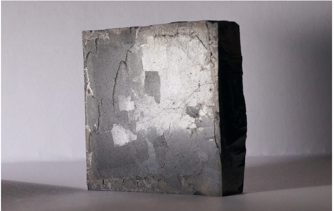
Afbeelding 3. De hogetemperatuursupergeleider YBCO De cupraat YBCO is supergeleidend tot bij 92 Kelvin.
