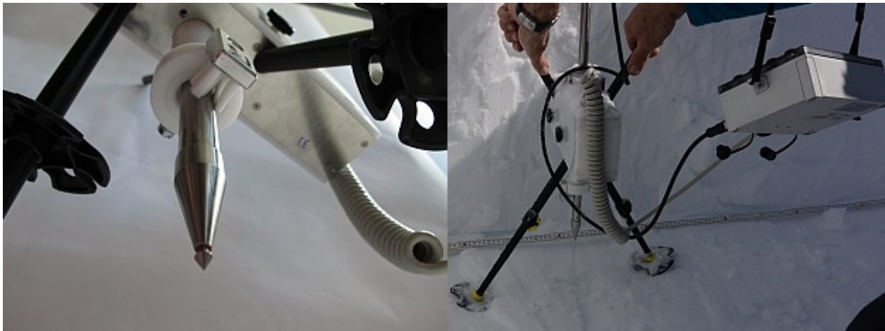
Afbeelding 6. Een SnowMicroPen in gebruik. Bron: SLF.
