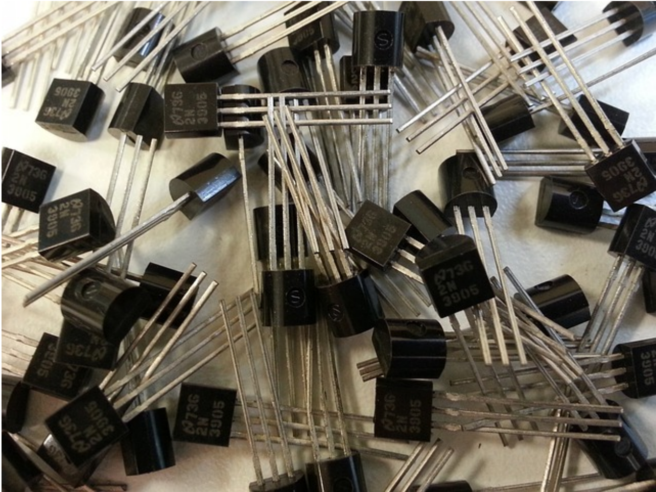
Afbeelding 5. Een verzameling transistoren. Elke transistor heeft drie aansluitpunten: de basis in het midden, en de twee buitenste aansluitpunten waarover de grote totale stroom loopt. Afbeelding:
