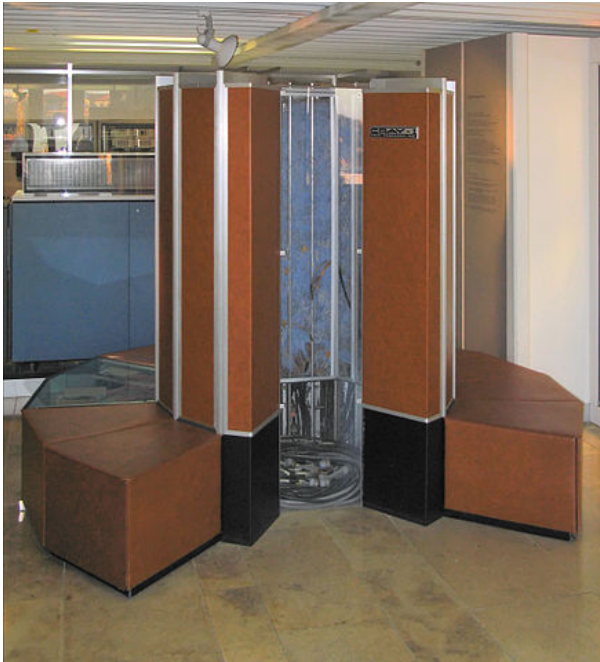
Afbeelding 2. De Cray-1-supercomputer. Eén van de eerste supercomputers, gebouwd in 1975. Een moderne telefoon rekent zo'n 50x sneller. Toch zullen ook de snelste gewone computers bepaalde wiskundeproblemen nooit kunnen oplossen. Foto: Clemens Pfeiffer.
