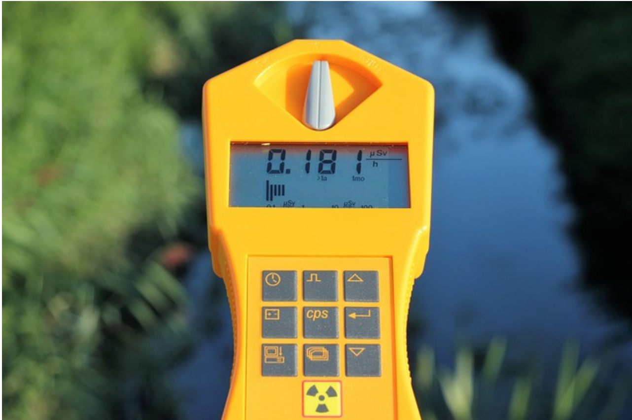
Afbeelding 1. Een geigerteller. Een geigerteller registreert hoe vaak er radioactieve stralingsdeeltjes passeren.
