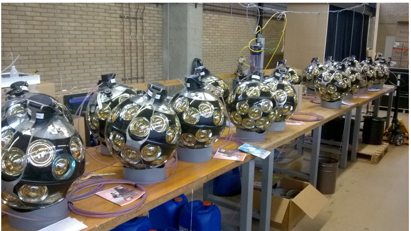
Afbeelding 4. De DOM's. Een kostbare tafel in het lab bij het Nikhef waar de DOM's geassembleerd worden, en met elkaar verbonden. Elk "oog" op de bol is een fotomultiplicator. Foto door Michiel Rollier.
