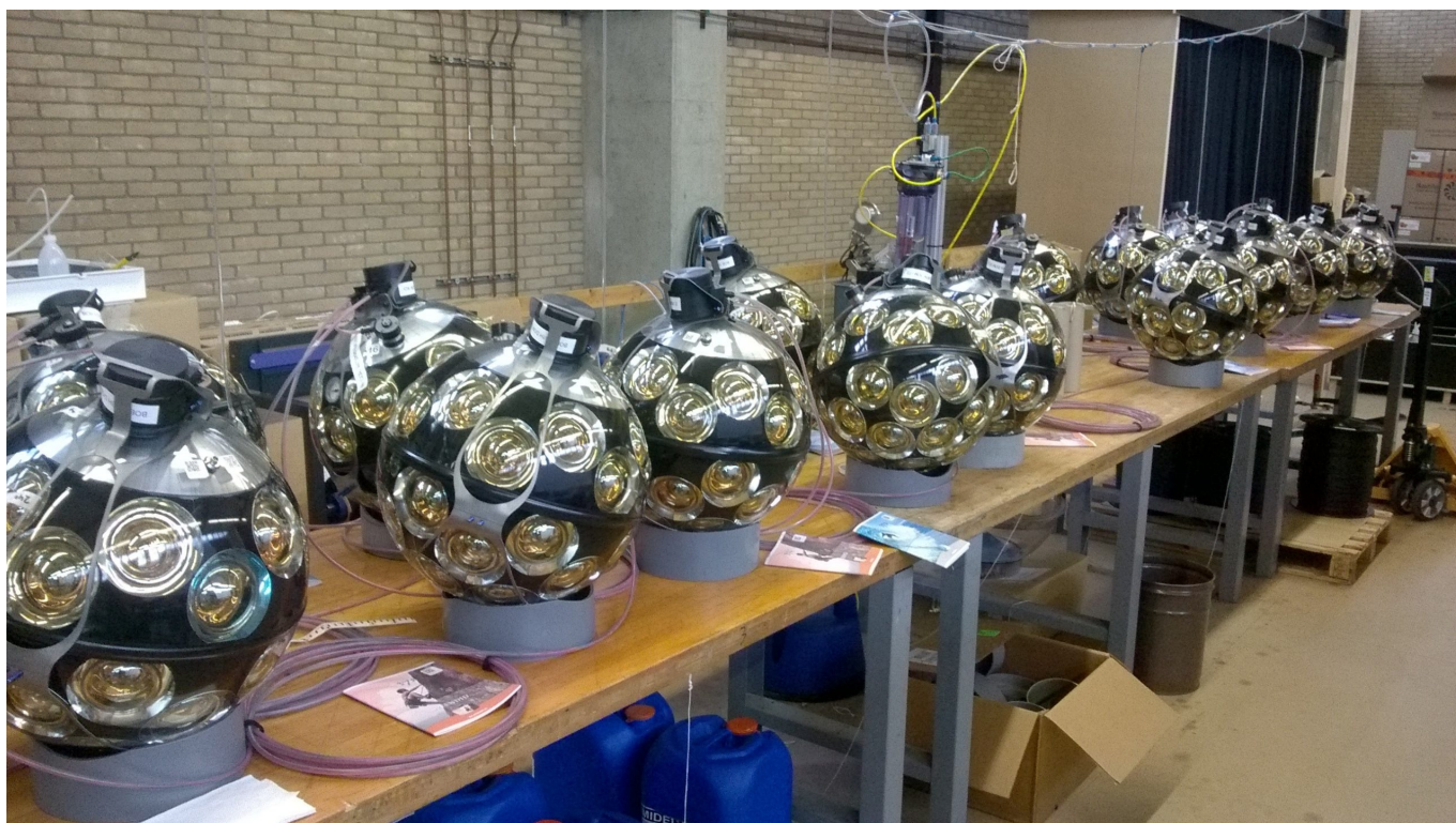
Afbeelding 4. De DOM's. Een kostbare tafel in het lab bij het Nikhef waar de DOM's geassembleerd worden, en met elkaar verbonden. Elk "oog" op de bol is een fotomultiplicator. Foto door Michiel Rollier.
