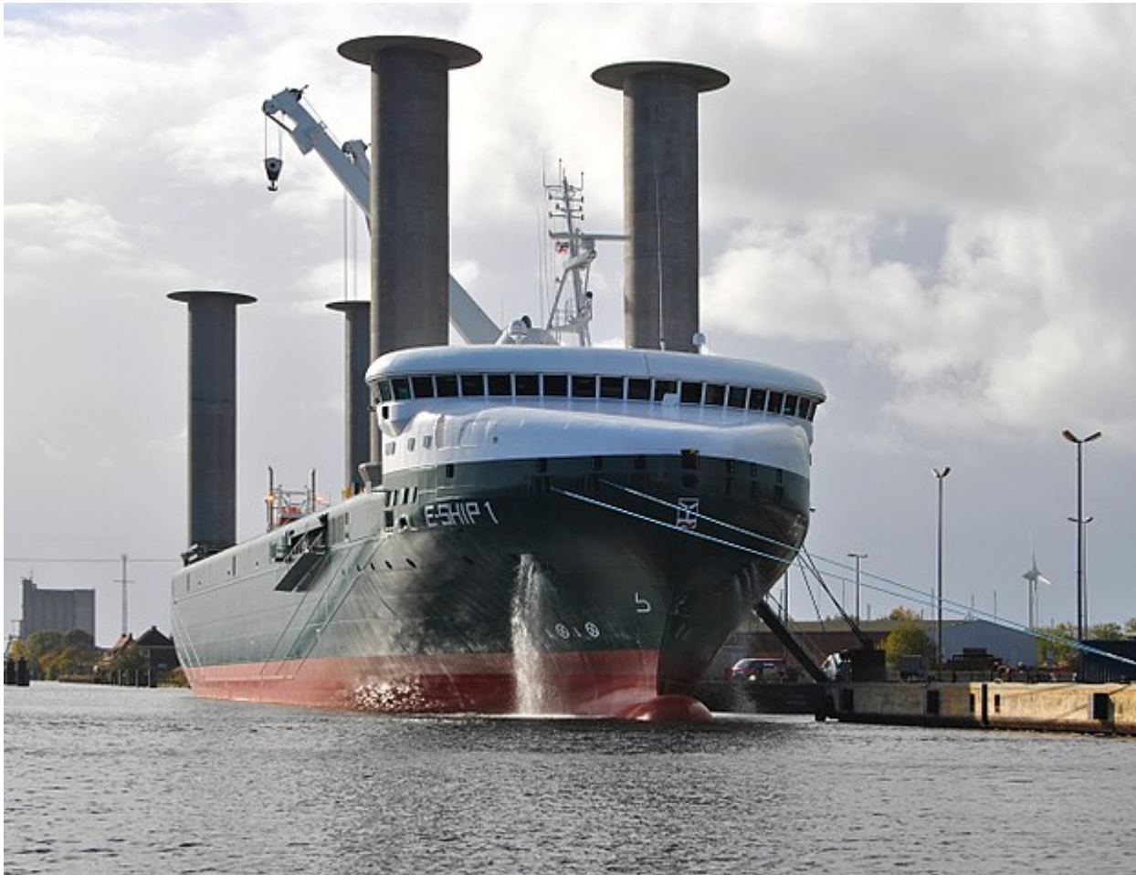
Afbeelding 2. Een roterschip. Een schip met een zogenaamde Anton Flettnerrotor: de draaiende cilinders veroorzaken een magnuskracht die de boot voortstuwt. Foto: Wikipedia-gebruiker Carschten .
