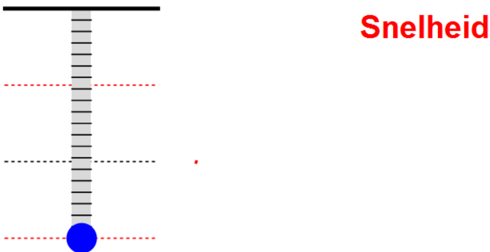
Afbeelding 4. De snelheid van een harmonische oscillator De snelheid is maximaal als de massa door de evenwichtsstand beweegt, en nul als de uitwijking maximaal is.
