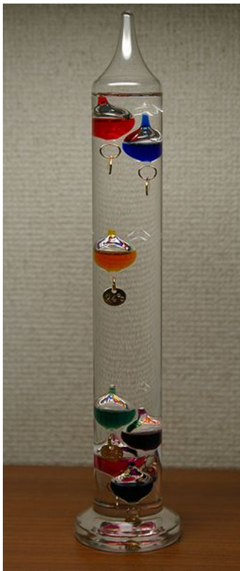
Afbeelding 1. Een thermometer. De thermometer met zwevende vloeistofbellen is een van de oudste soorten gesloten thermometers. Foto: Wikipedia-gebruiker Hustvedt.
