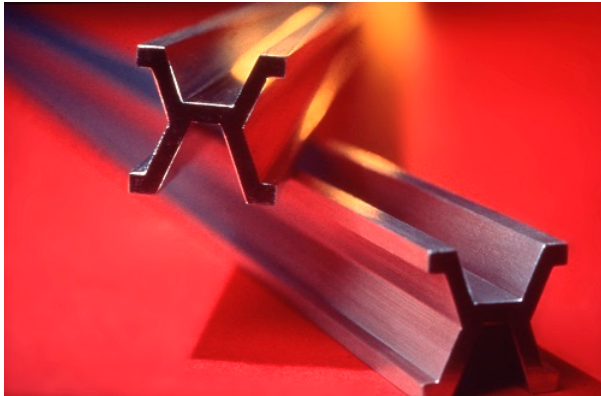
Afbeelding 1. De meter. De historische platina-iridiumstaaf die vroeger de lengte van de meter bepaalde. (Foto: National Institute of Standards and Technology.)
