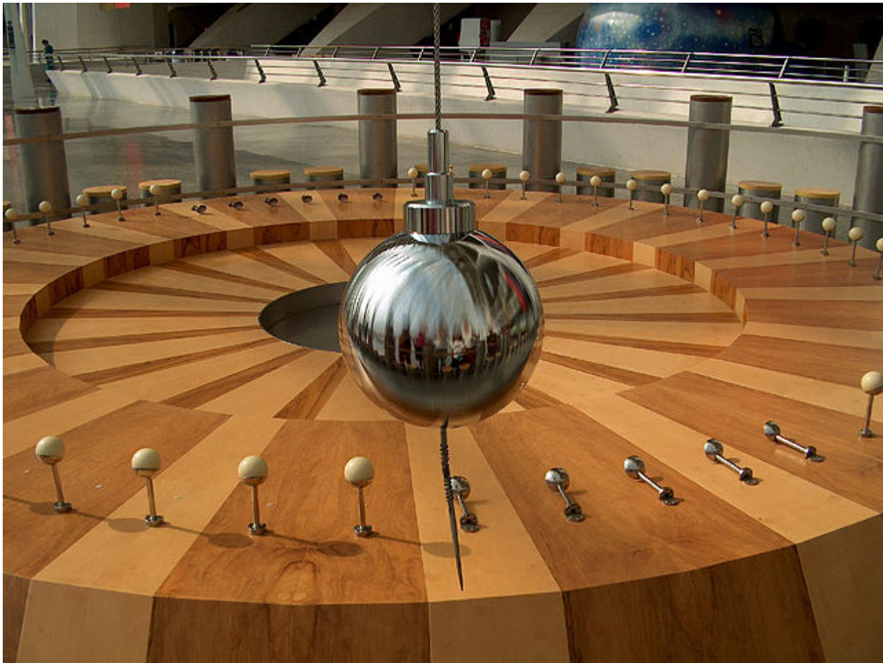
Afbeelding 3. De slinger van Foucault. Eén van de beroemdste typen slingers. Hoe lang de slingertijd is kun je, zonder ingewikkelde wiskunde, grotendeels bepalen met dimensie-analyse!
