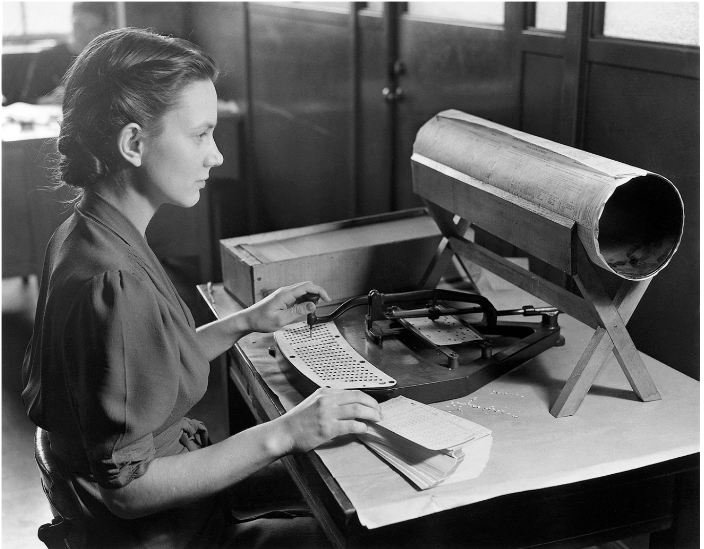
Afbeelding 2. Het maken van een ponskaart. Ponskaarten hebben gaten (1) en dichte plekken (0), de bits van de vroege computer.
