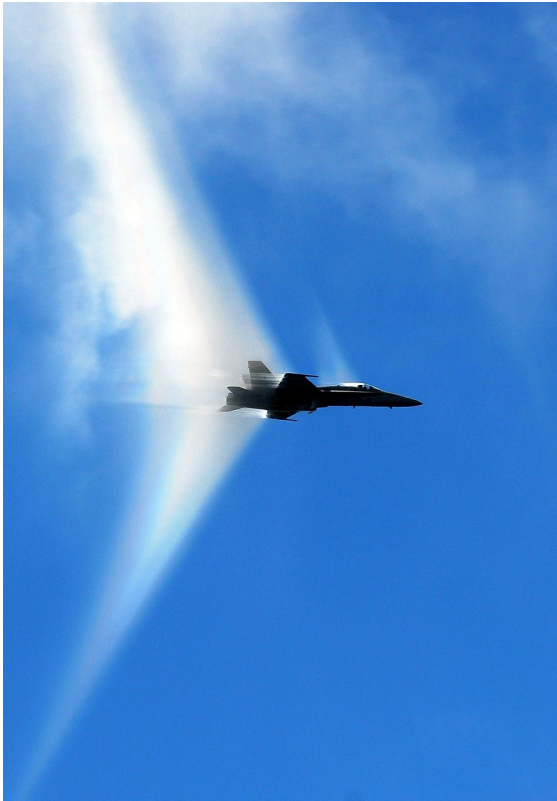
Afbeelding 2. Een schokgolf. Een vliegtuig dat door de geluidsbarrière breekt, veroorzaakt een schokgolf. Foto: skeeze .
